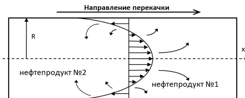
Рис. 1. Схема процесса смесеобразования в зоне контакта партий последовательно движущихся нефтепродуктов
