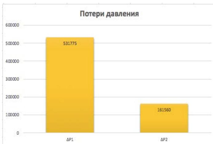
Рис. 2. Сравнение потерь напора и давления при перекачке нефти с введением растворителя
