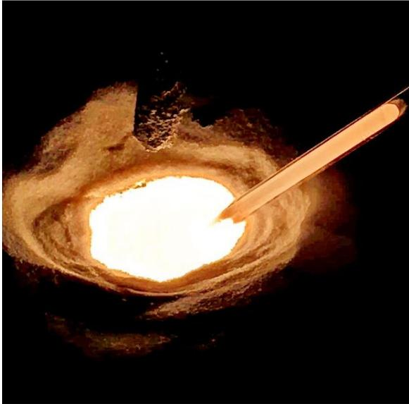
Рис. 1. Отбор огненно-жидкой пробы из расплава
