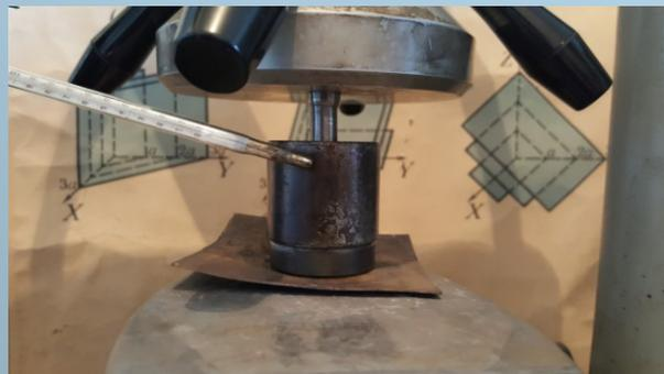
Рис.3. Синтез в пресс-форме при  $t^{\circ} = 140 - 150^{\circ}\text{C}$
