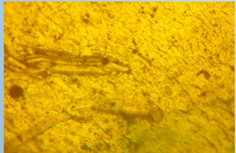
Рис. 10. Фото образца 30%  $\alpha$ -Fe/ 35%MP/ 35%SiI
