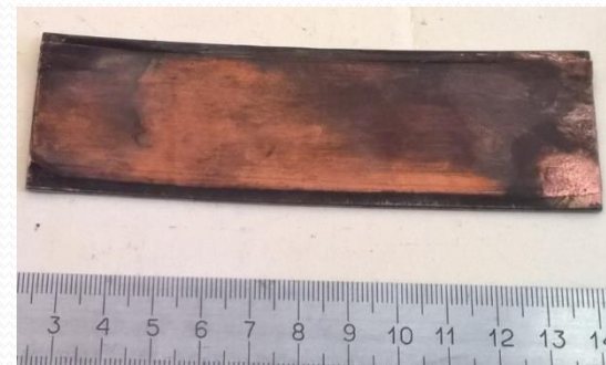
Внешний вид и снимок шлифа сваренных пластин образца медь- сталь
