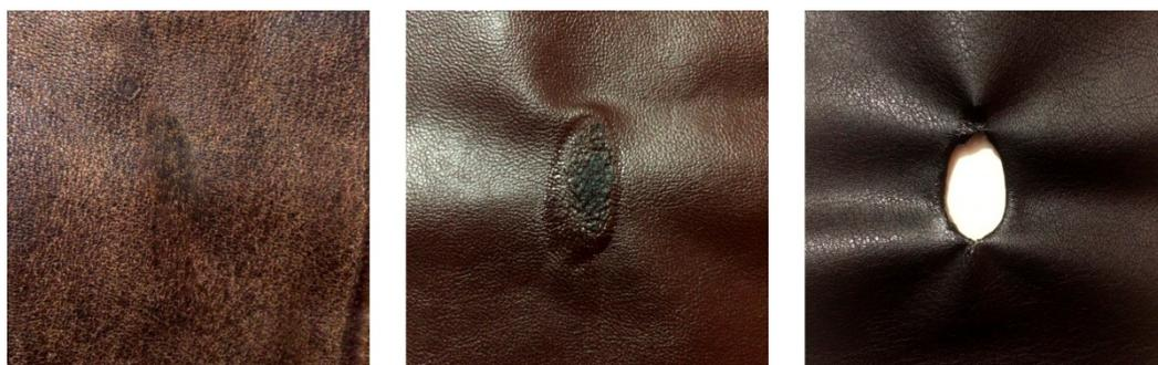
Рис. 1. Определение термостойкости натуральной кожи (слева), искусственной кожи (по центру) и экокожи (справа)
