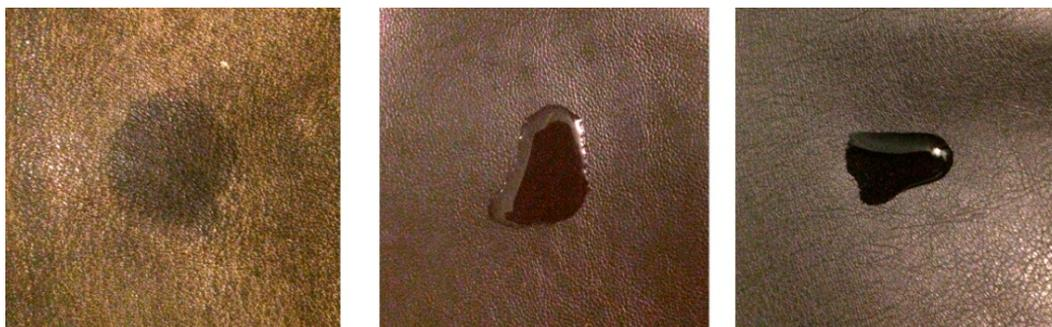
Рис. 3. Определение водостойкости натуральной кожи (слева), искусственной кожи (по центру) и экокожи (справа)
